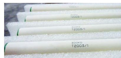
Fig. 5 : Photo du marquage au laser sur les membranes
