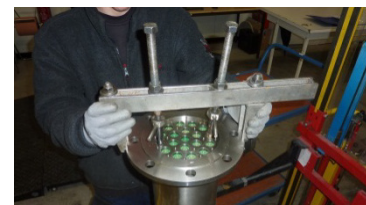
Mise en place de l'extracteur de contreplaque
