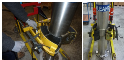
Module emprisonné dans les mâchoires
