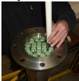
Montage des membranes
