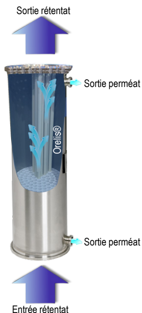
Passage du produit au travers des canaux des membranes céramiques
