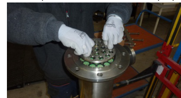
Extraction de la contreplaque
