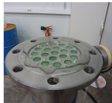
Bulloscopie : (bubble test) test d'intégrité de l'étanchéité du carter, des membranes et des joints
